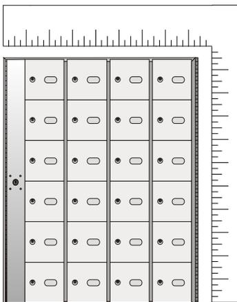
Les boîtes doivent être parfaitement équerries lors de l'installation pour un bon fonctionnement des portes et un alignement juste avec le cadre/structure de l'ouverture.
